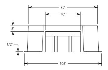
**NOTE 1:**  $\emptyset$  1/2"-13 UNC LIFTING INSERTS WILL BE CAST INTO BOX PAD.
